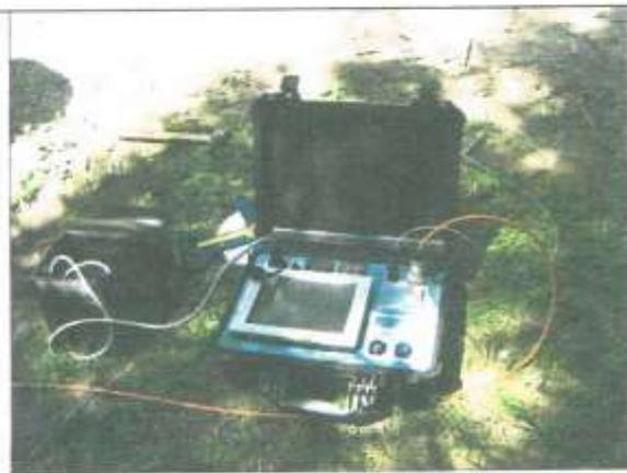
Statia seismica si de rezistivimetrie multicanal Pasi
